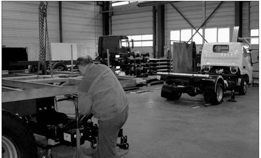
A Tornádó International egyik szerelőcsarnoka: felépítményeket szerelnek az alvázakra.
